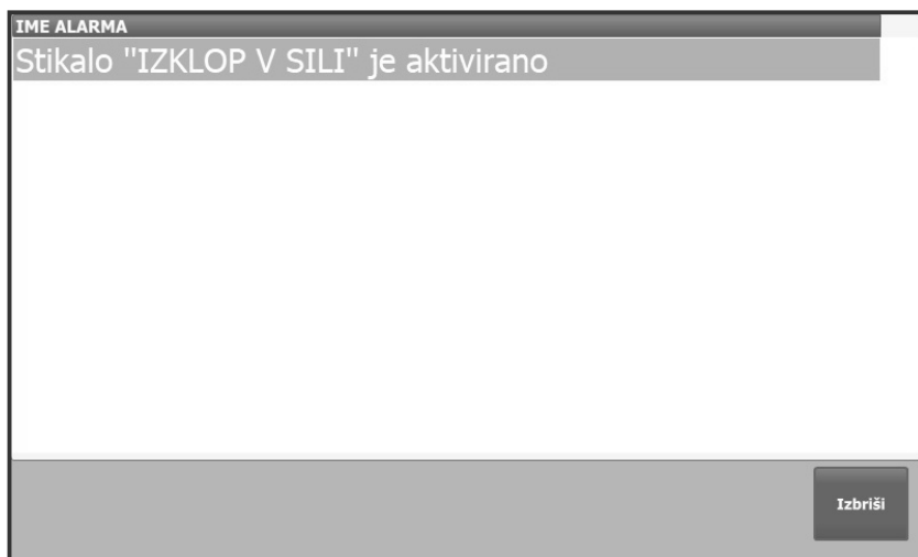
Videz operacijske plošče snežnega topa - zaslon okvare
