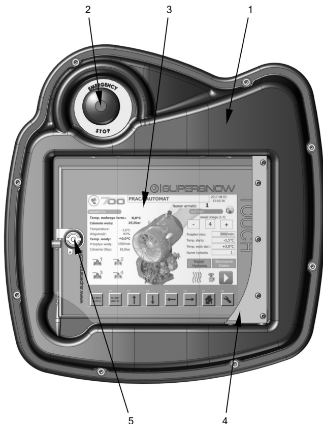
Descrierea construcției panoului de control al tunului de zăpadă 700ASE, 700H, 700S, 900A
