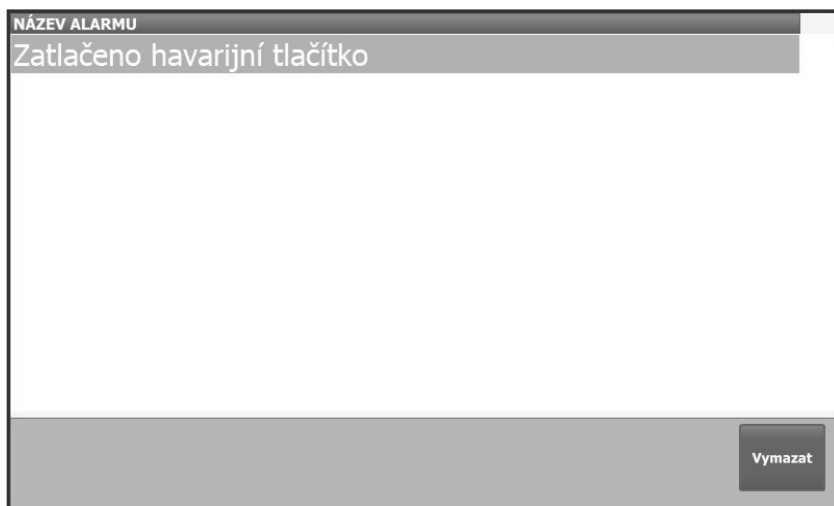
Vzhled panelu obsluhy sněhového kanónu – obrazovka selhání
